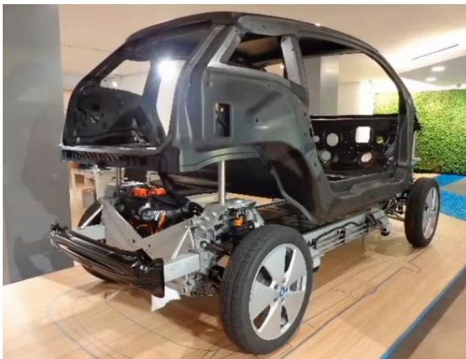
Alu-Chassis und Carbonzelle Quelle BMW
