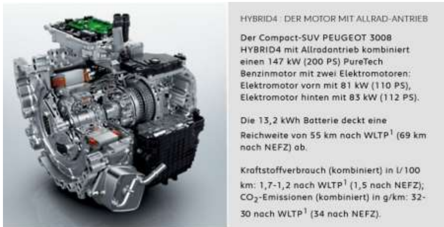
Elektrischer Teil des Hybridmotors
