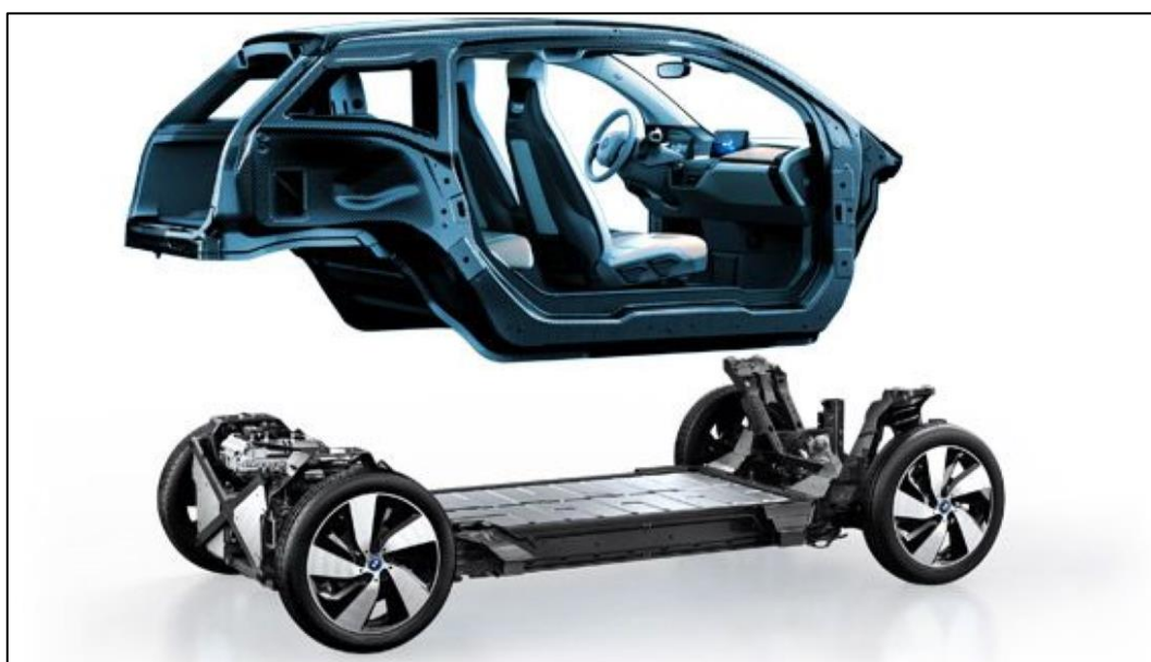
Unten: BMW i3 Chassis mit Fahrwerk und Batterie. Oben: Karosserie aus Carbon
