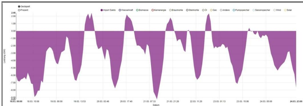
Das Diagramm zeigt das Geschehen innerhalb einer Woche im März 2019. Alles unterhalb der Null-Linie ist überschüssiger Strom und wird an der Strombörse verkauft, die kleinen Zacken über der Nulllinie sind eingekaufter Strom.
