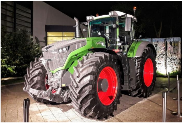
Fendt Vario: 6-Zylinder MAN-Motor, 12,4 Liter Hubraum, Leistung 517 PS, Leergewicht 14 Tonnen, Allradantrieb mit Torque Distribution, Reifendurchmesser max. 2,35 Meter, Vmax. 60 km/h, variable Reifendruckanlage, 3-fach pneumatische Kabinenfederung mit integrierter Niveauregulierung, aktiv gekühlte Kühlboxen, ca. 250.000 Euro
