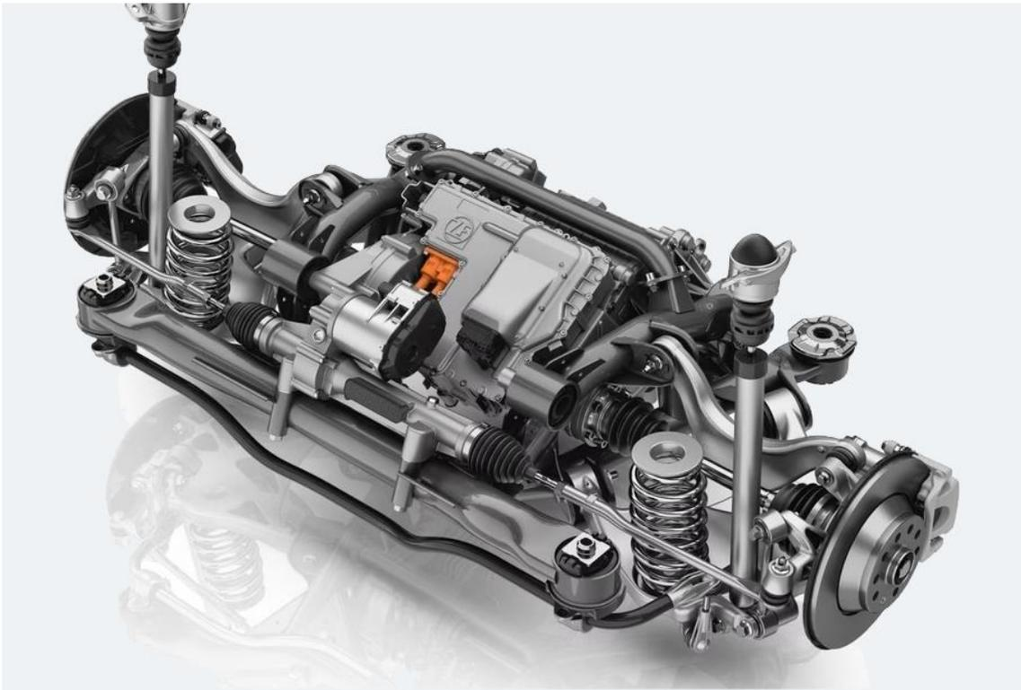
**Hinterachse mit integriertem Elektroantrieb 150 kW und HA-Lenkung**
